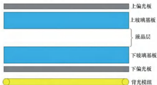
图 2.1 TFT-LCD 基本结构
